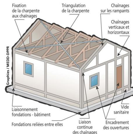
Le respect des règles de construction parasismique ou le renforcement de sa maison permettent d'assurer au mieux la protection des personnes et des biens contre les effets des secousses sismiques.
